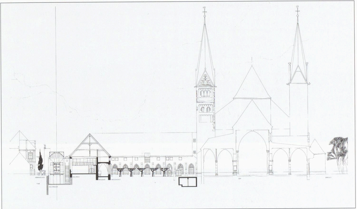
Abb. 20: Schnitt durch die Glashalle und den Kreuzhof, Eingabeplanung März 1990
